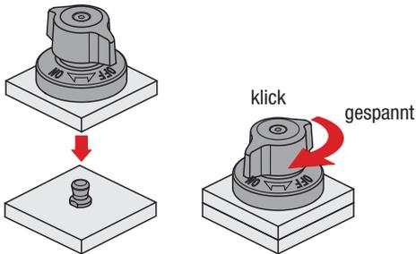
Sicherstellen, dass der Drehkopf auf Position „OFF“ steht. Den Drehspannverschluss über den Spannbolzen setzen und den Drehkopf auf Position „ON“ drehen. Bei vollständiger Klemmung ist ein Klicksignal zu hören.
